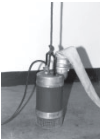
Arbeitsleine mit Mastwurf und halbem Schlag befestigt
